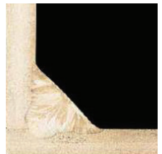
PB MAG (135) Aço Inoxidável Austenítico 3mm, utilizando Inolinx MAG
