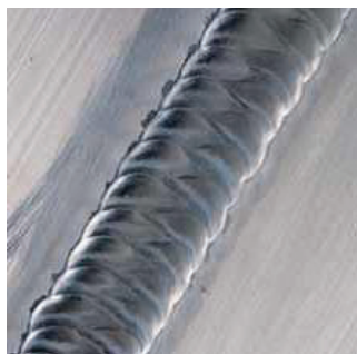
Soldagem TIG em liga de alumínio 4140 com 10mm de espessura usando o gás Alulinx®
